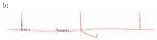
Rys. 7. Deformacja konstrukcji ramowej: a) w płaszczyźnie z-x, b) w płaszczyźnie x-y
