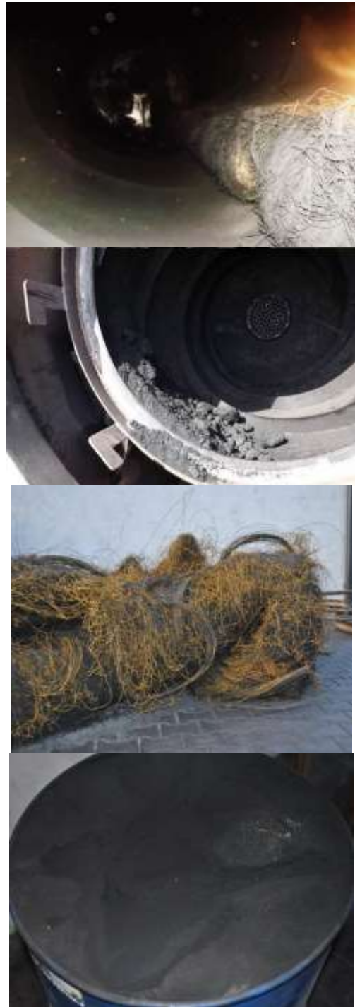
Rys. 7. Stałe produkty termolizy odpadów wielomateriałowych przed i po wyjęciu z reaktora.
