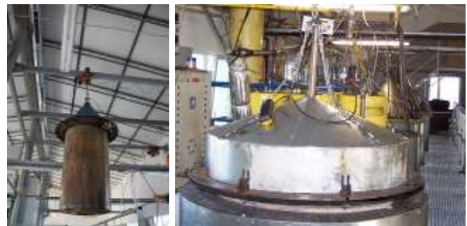
Rys. 6. Urządzenie do pirolizy opon i wielomateriałowych odpadów użytkowych z wymiennymi komorami reakcyjnymi – Eko-Kon Sp. z o.o. w Bojanie.
