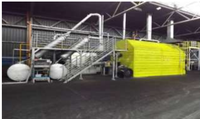
Rys. 9. Przemysłowa instalacja do odzysku materiałowego i energetycznego z obrotową poziomą komorą reakcyjną – WGW Green Energy Sp. z o.o.
